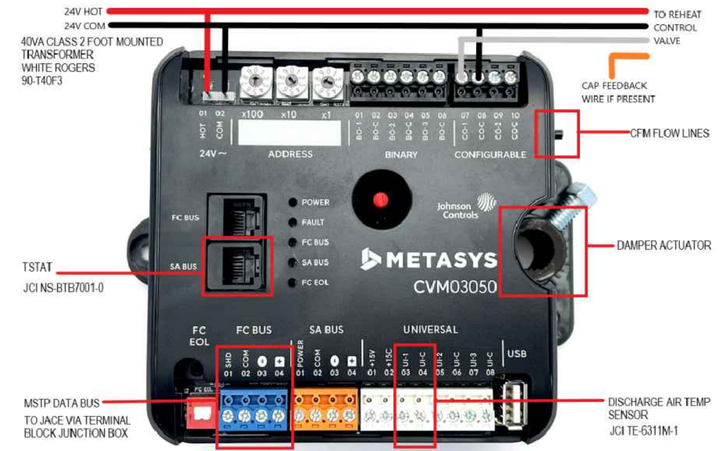
2 ASC CONTROLLER WIRING DIAGRAM Scale: NONE
